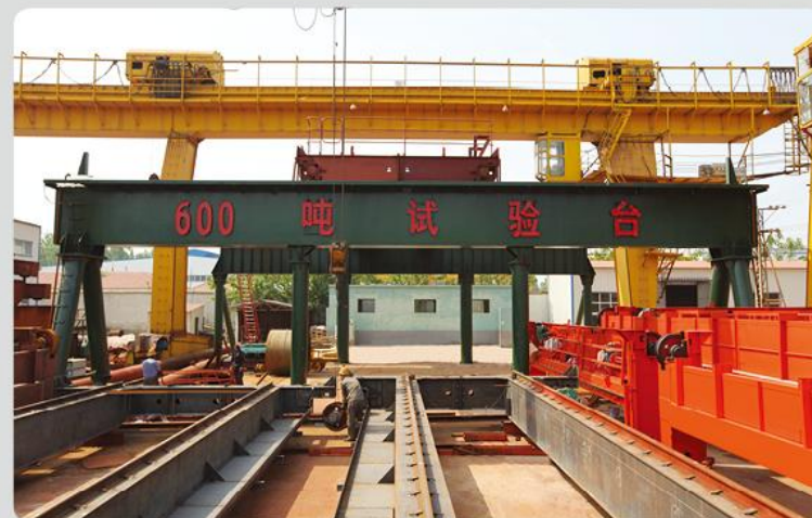
600吨桥式起重机试验台 600t bridge crane test bed
