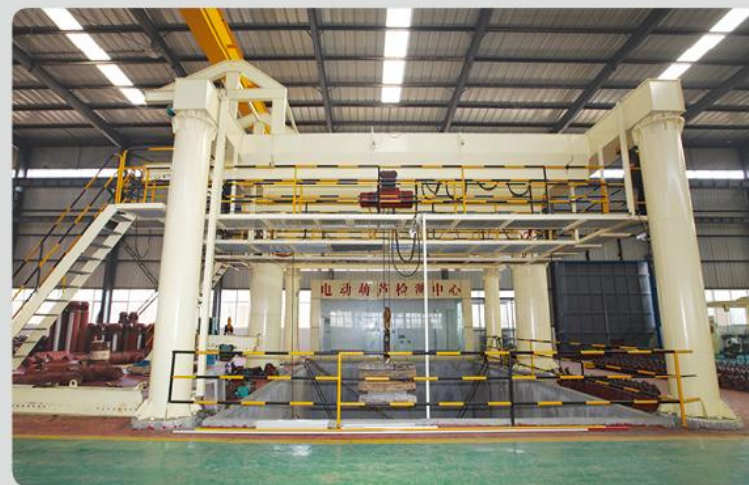
电动葫芦试验台 Electric hoist test bed
